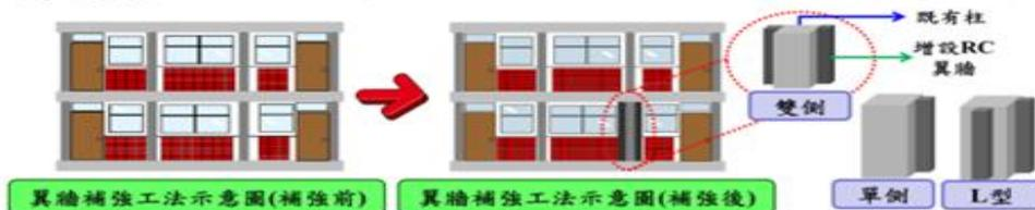
**增設剪力牆補強：**於既有梁、柱構架內加設整片RC牆體。
